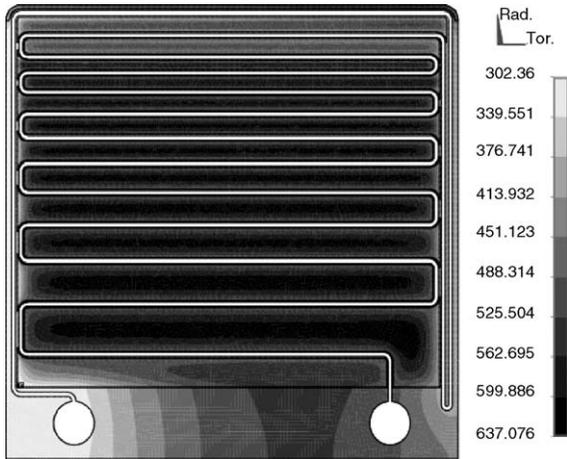
Fig. 6. Temperature distribution of blanket module (°C).
